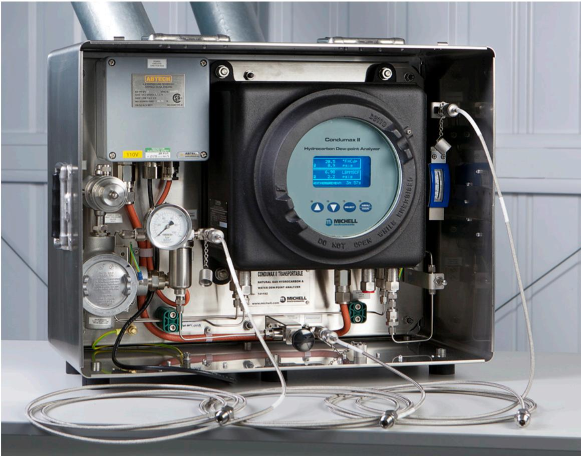
Un completo y portátil sistema de análisis de punto de rocío de gas natural para medidas discretas en campo. Funcionamiento periódico en línea si se ubica en caseta de análisis con temperatura controlada. Acceso inmediato a las mediciones y funciones a través de la pantalla integrada alfanumérica y la interfaz HMI táctil, incluido el registro de lecturas de punto de rocío.
